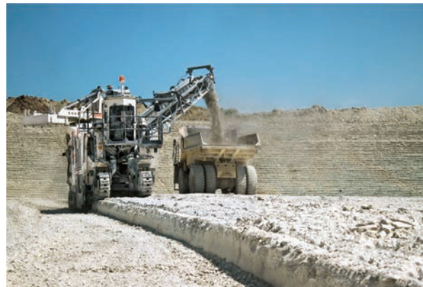
شکل ۴- استخراج آهک به وسیله ماشین استخراج سطحی [۱]
